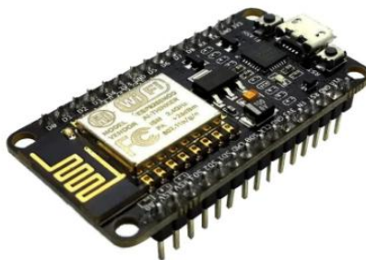
Рисунок 2.9 – Зовнішній вигляд WiFi модуля ESP8266
